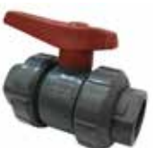
VÁLVULA BOLA PVC DOBLE UNIÓN AMERICANA HILO MARCA: HIDROTEN (ESPAÑA) JUNTA DE CIERRE EN EPDM / HILO BSP MANILLA EN POLIPROPILENO CON FIBRA DE VIDRIO UNIDAD DE VENTA: UNITARIO
