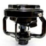
ASPELOR AGRÍCOLA DE IMPACTO LF 2400 MARCA: RAIN BIRD (U.S.A.) MEDIDA: 1/2" HE TRABAJO: ENTRE 1,7 Y 4,2 BARES SEGÚN ELECCIÓN DE BOQUILLAS, DEFLECTOR Y PRESIÓN: RADIO DE MOJAMIENTO ENTRE 8,1 Y 15,2 M CAUDALES DESDE 384 A 1.488 L/H GARANTÍA: 5 AÑOS UNIDAD DE VENTA: UNITARIO
